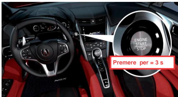
Procedura di spegnimento dell'alta tensione
