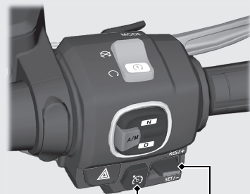
Leva di controllo velocità di crociera Interruttore principale controllo velocità di crociera
