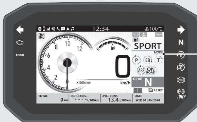
Non azionare le funzioni del display per un lungo periodo di tempo a motore spento. Ciò potrebbe scaricare (o esaurire) la batteria.
